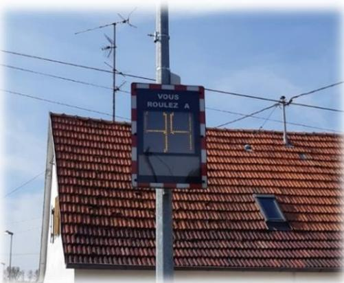
Afin de pouvoir mesurer l'efficacité de ces réalisations sur la vitesse des véhicules, nous avons fait déplacer le radar pédagogique au niveau du 9 rue de Hatten. A cet endroit, nous nous situons entre deux écluses (l'une située devant le cimetière et l'autre en entrée – sortie de village direction Hatten) et pouvons mesurer concrètement le phénomène de réaccélérations (ou pas) des véhicules passant à cet endroit.
